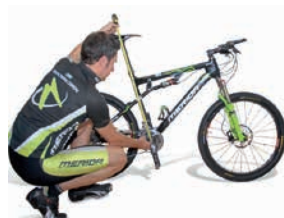
1 Mérésnél a hajtókar legyen párhuzamos az ülésvázcsővel!
