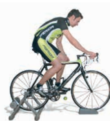
3 Nyereg vízszintes pozíciója: a térd épp a pedáltengely felett legyen.
